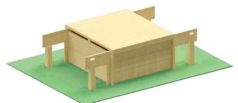
Les pieds s'enterrent de 50cm et doivent être bétonnés (excepté sur la gamme Basic Play).
