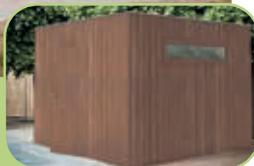
Design épuré : bardage vertical, planchettes d'un seul tenant. Sous-toiture en OSB et couverture EPDM avec gouttière intérieure et bord du toit en alu ou noir. Fenêtre avec vitre claire 30 x 160 cm ( sur flanc gauche).
