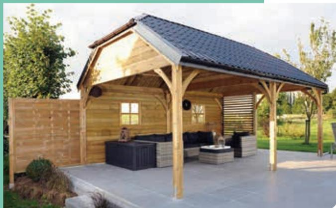
Superbe abri pour votre mobilier de jardin ou votre cuisine d'été, ce modèle est équipé de deux châssis fixes sur la cloison arrière et d'une persienne orientable. Il est équipé d'une ferme centrale, de planches de sous-toiture à profil Z et d'une couverture de toit en panneaux-tuiles.
